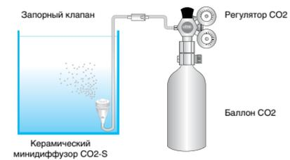
Диффузор CO2 конусный компактный
